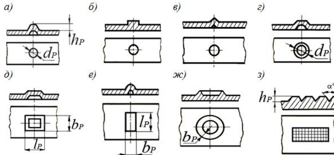
Рис. 7.9. Разновидности рельефов при конденсаторной рельефной сварке
