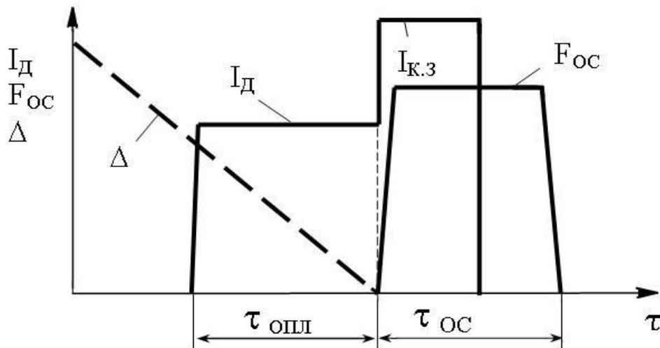
Циклограмма процесса УКС с предварительным зазором между свариваемыми деталями:  $I_D$  – ток дуги;  $I_{кз}$  – ток короткого замыкания;  $F_{ос}$  – усилие осадки;  $\Delta$  – величина зазора между свариваемыми деталями;  $\tau_{опл}$  – время горения дуги;  $\tau_{ос}$  – время осадки
