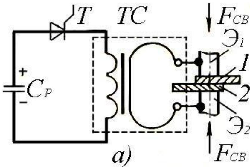
При трансформаторной конденсаторной сварке батарея конденсаторов  $C_p$  через тиристор  $T$  разряжается на первичную обмотку трансформатора сварочного  $TC$ . Во вторичной обмотке, которая обычно состоит из одного витка, индуцируется импульс тока. Сварочные электроды  $\mathcal{E}_1$  и  $\mathcal{E}_2$  сжимаются усилием  $F_{св}$ . Через детали  $1$  и  $2$  протекает сварочный ток, в зоне контакта деталь–деталь образуется сварная точка.
