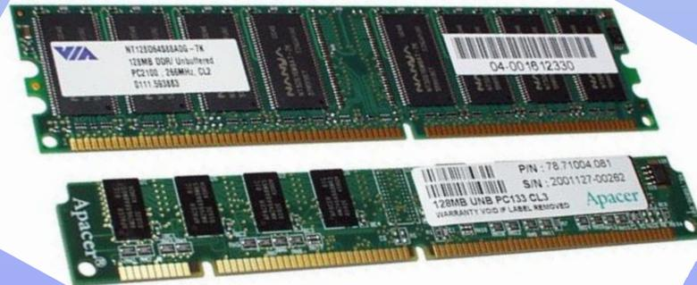
На СП может быть несколько групп разъемов – банков для установки модулей памяти; в один банк можно ставить лишь блоки одинаковой емкости. Модули памяти характеризуются конструктивом, емкостью, временем обращения и надежностью работы.
