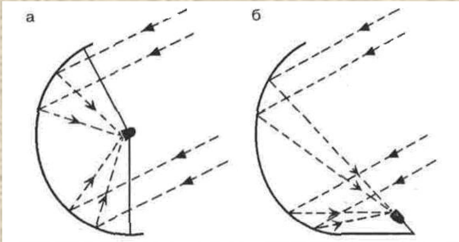
**Рисунок 2 – Принцип фокусировки параболических антенн:
