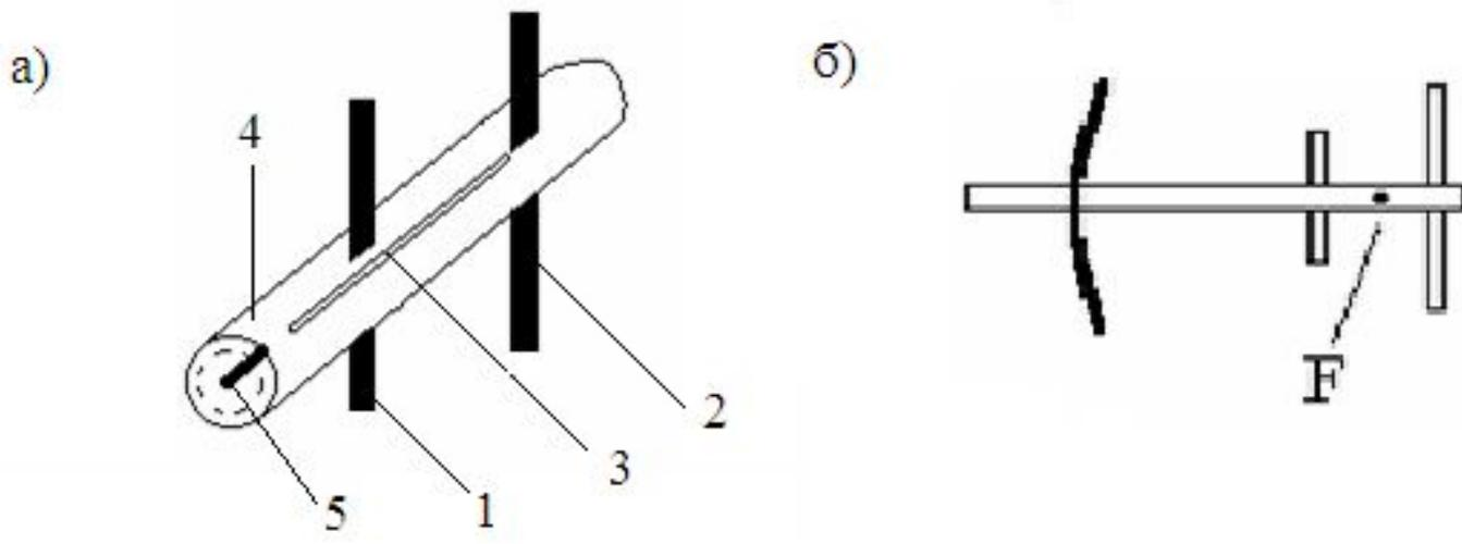
Рисунок 9 – а) двух вибраторный облучатель; б) крепление двух вибраторного облучателя: 1 – активный вибратор; 2 – пассивный вибратор; 3 – симметрирующая полуволновая щель; 4 – оплетка жесткого коаксиального кабеля; 5 – центральная жила
