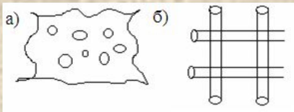
**Рисунок 6 – Исполнение перфорированных зеркал:**
