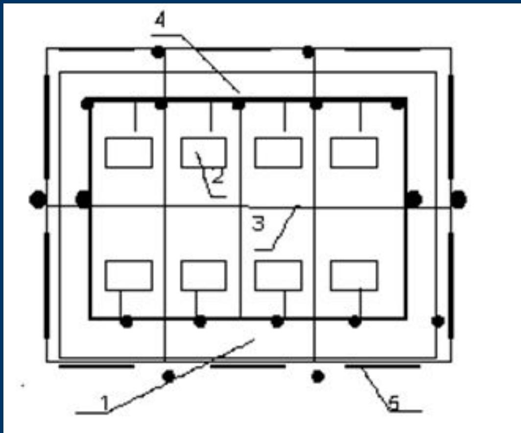
**Контурное заземляющее устройство** характеризуется тем, что его одиночные заземлители размещают по контуру площадки, на которой находится заземляемое оборудование, или распределяют по всей площадке по возможности равномерно.
