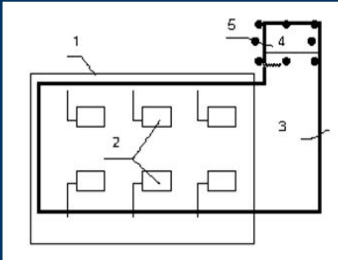
**Выносное заземляющее устройство** характеризуется тем, что заземлитель его вынесен за пределы площадки, на которой размещено заземляемое оборудование, или сосредоточен на некоторой части этой площадки.
