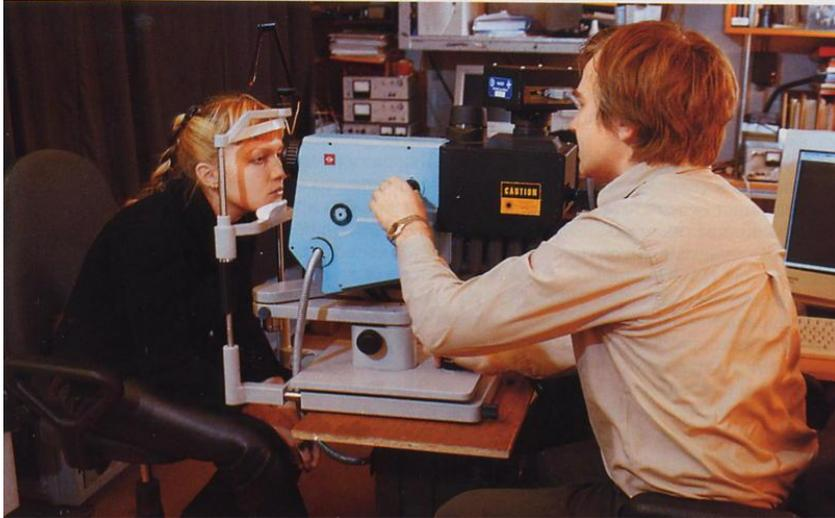
Уникальный офтальмологический диагностический прибор. Позволяет получить изображения глазного дна с высоким разрешением (до 1 мкм) и одновременно производить оптометрические измерения с точностью 0,02 мкм.
