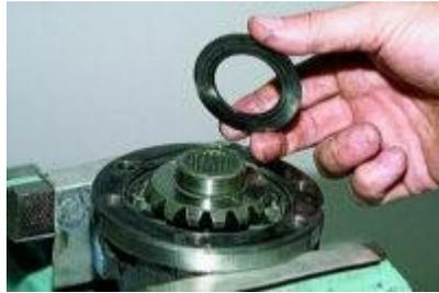
С шестерни привода переднего моста снимаем опорную шайбу...
