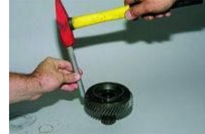
Сбиваем ее с корпуса через выколотку из мягкого металла.
