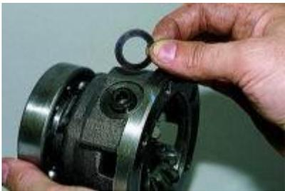
Снимаем пружинную шайбу оси сателлитов.
