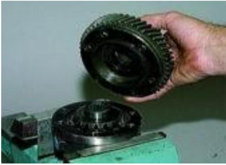
Разъединяем передний и задний корпуса дифференциала.
