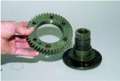
Разъединяем ведомую шестерню и передний корпус дифференциала.
