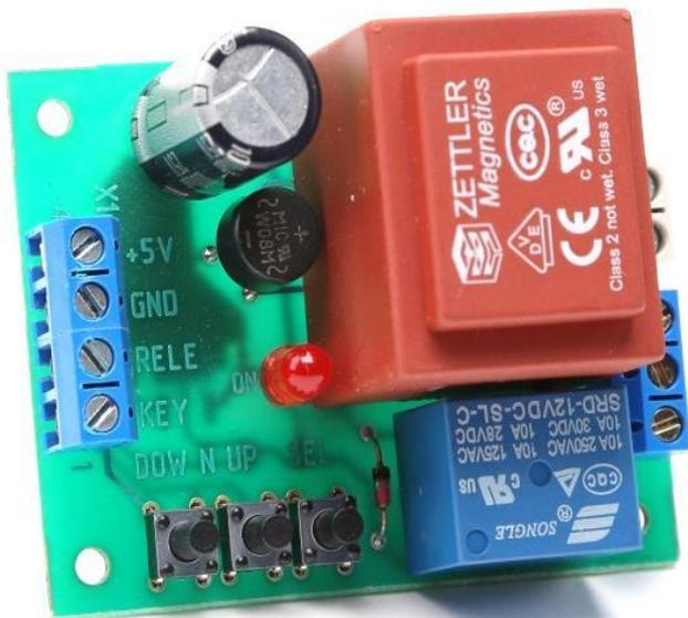
Универсальный модуль предназначенный для совместной работы с изделиями линейки Master Состоит из стабилизированного блока питания, релейного коммутатора и кнопок управления.
