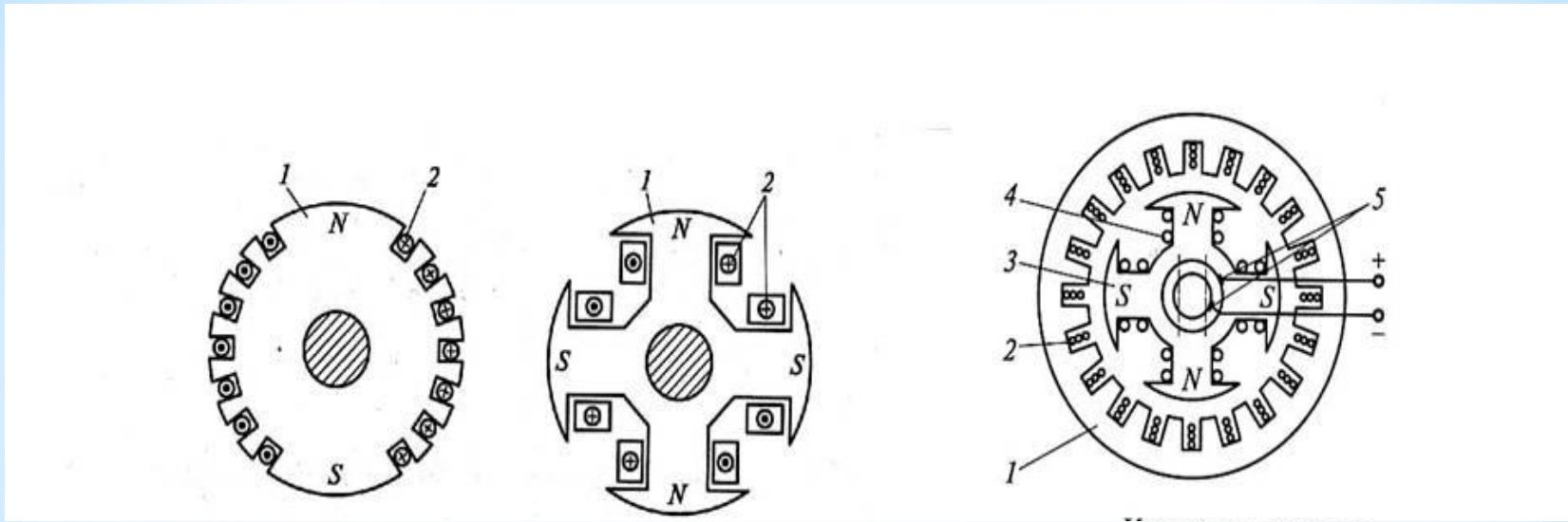
Суретте синхронды машинаның құрылымдық схемасы келтірілген:
