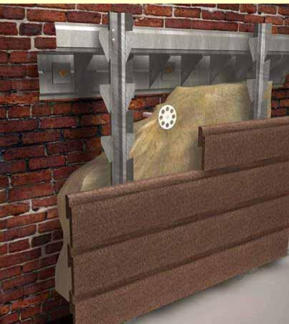
Схема вентилируемого фасада СКАНРОК
