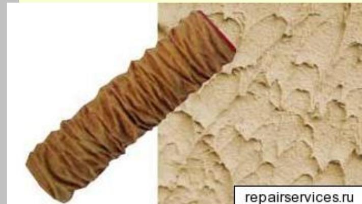
**Штукатурки терразитовые** - это сухие смеси, состоящие из цемента, гидратной извести и заполнителя в виде кварцевого песка, крошки (мрамор, гранит, известняк, слюда), пигмента, пластификаторов и применяемые для оштукатуривания цоколя, поверхностей стен.
