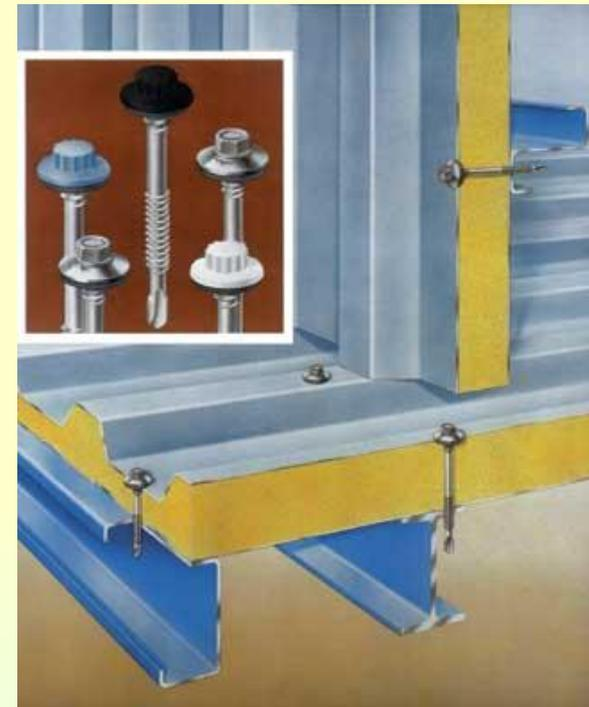
Сэндвич-панели – это готовая навесная конструкция стены, состоящая из двух стальных листов с изоляционным материалом между ними. Панели имеют полимерные покрытия из полиэстера или ПФФ2. Ширина панели – 1200 мм, толщина – 80-200 мм, длина – до 12 м. Толщина металла – 0,6 мм. Масса - 28,1 кг/м<sup>2</sup>. Сндвич-панели позволяют максимально сократить сроки возведения новых зданий, реконструкции и модернизации устаревших построек.
