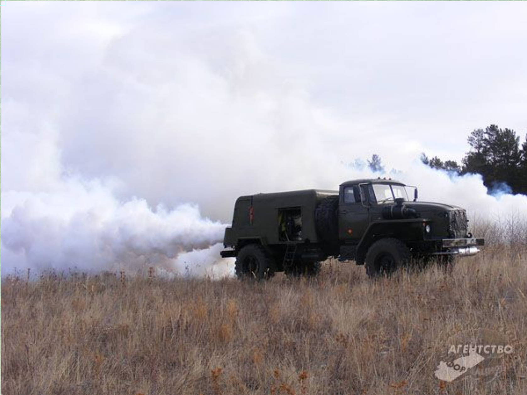
Фото 19. Постановка аэрозольной завесы с использованием ТДА-2М
