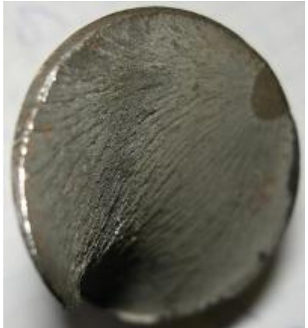
Коррозионно-усталостный излом рулевой полуоси
