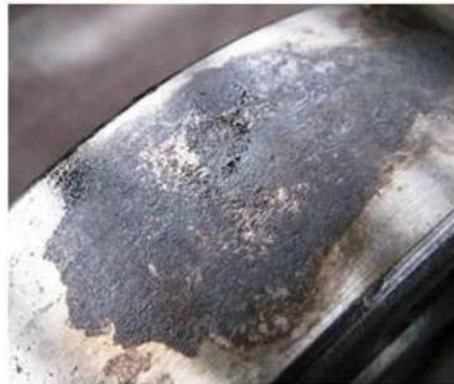
**Фреттинг - коррозия** – это коррозия, возникающая на контактирующих металлических поверхностях при минимальном повторяющемся (локальном) перемещении этих поверхностей относительно друг друга в условиях воздействия коррозионной среды. Причиной таких перемещений могут быть вибрации, динамические нагрузки, периодический изгиб или скручивание сопряженных деталей.
