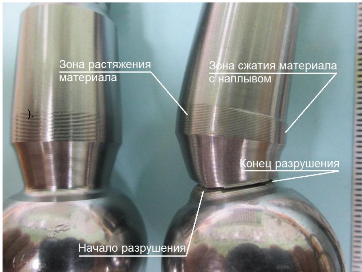
**Рис.32. Вязкое разрушение шарового пальца рулевого наконечника.**
