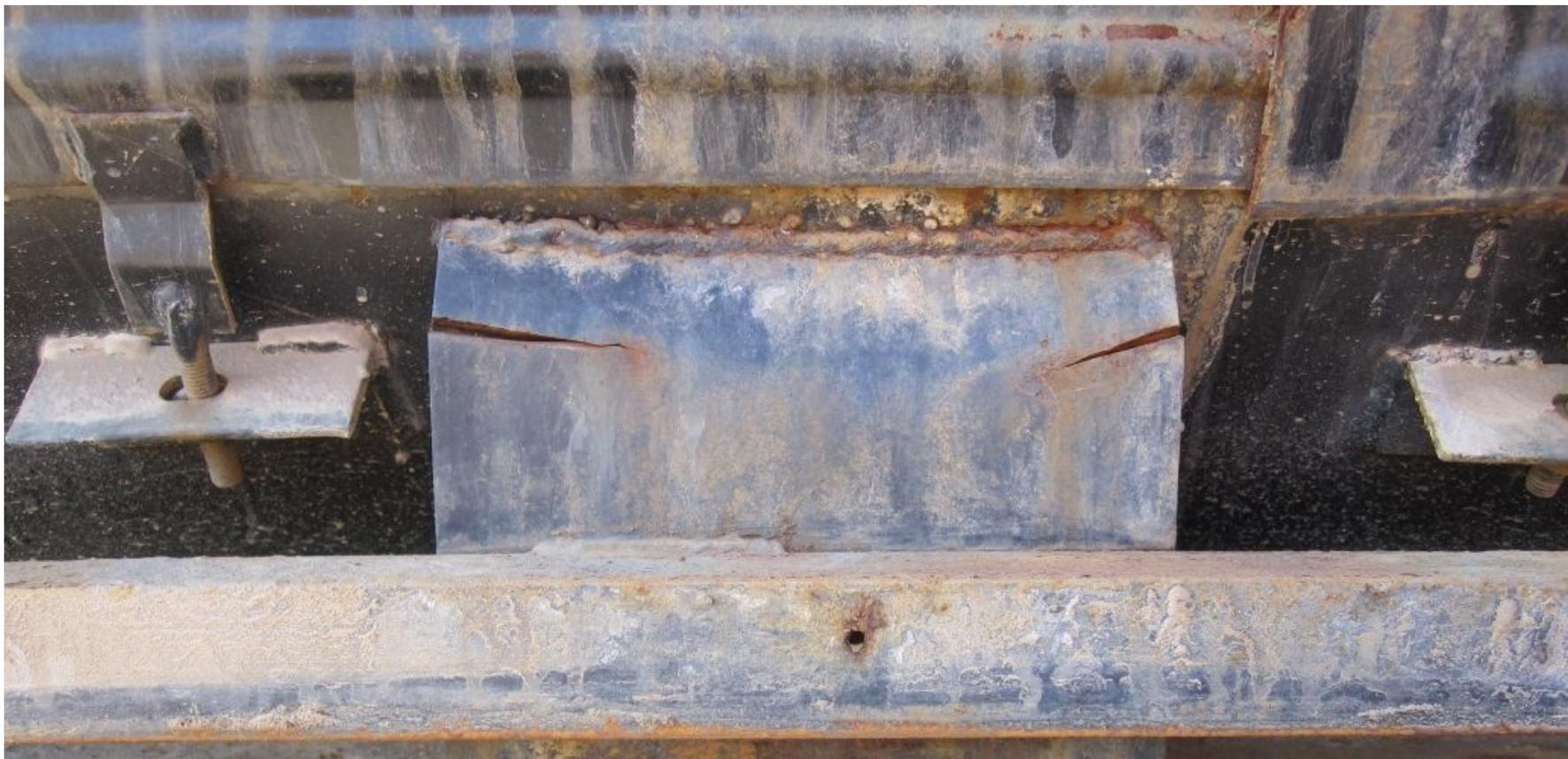
Рис. 8. Из-за нарушения технологии сварки внутренние напряжения в металле превысили допустимые значения, наблюдается разрыв основного металла
