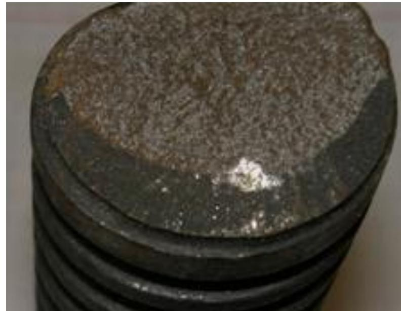
Коррозионно-усталостное разрушение детали рулевого механизма
