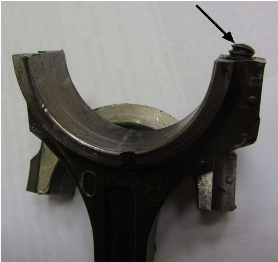
**Рис.11. Изогнутый второй шатунный болт (показан стрелкой).**
