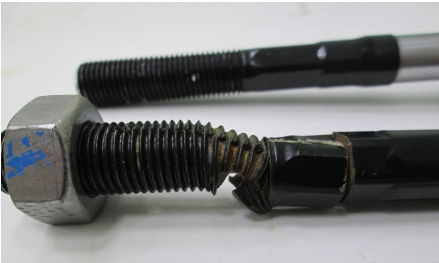
Рис. 31. Рулевая тяга разрушилась при ДТП, в месте разрушения сильный изгиб резьбовой части. Фрагменты излома не совмещаются. Это свидетельствует об ударной нагрузке, приложенной с большой скоростью
