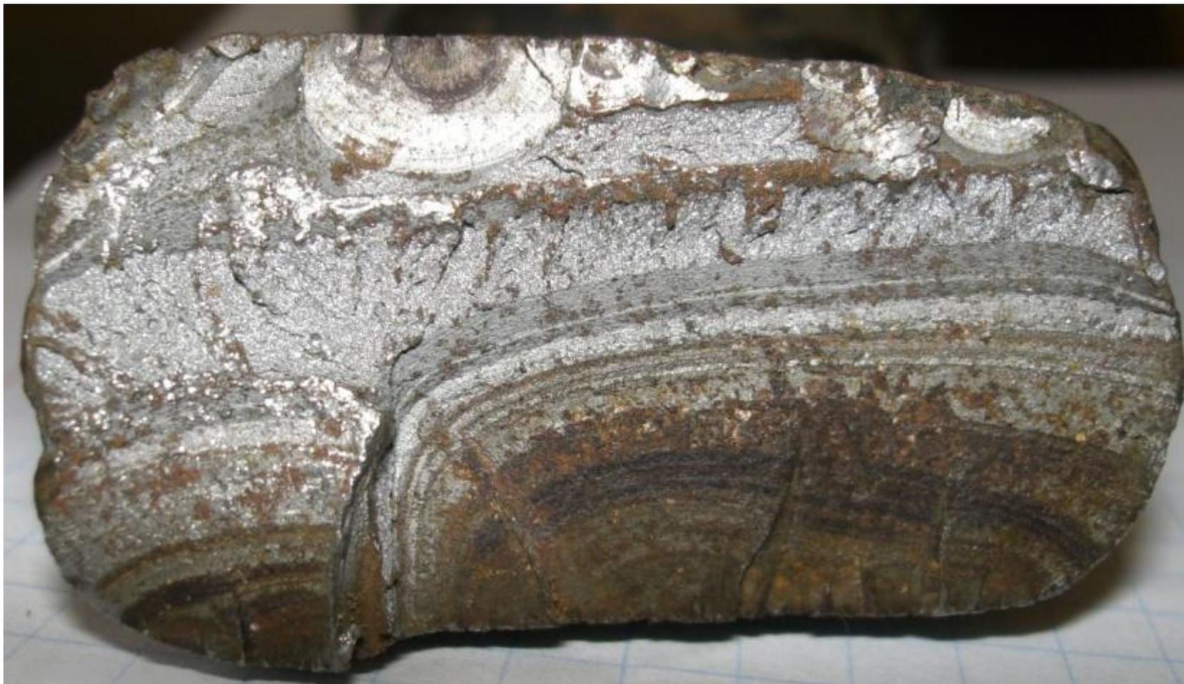
Коррозионно-усталостный излом рулевой сошки автомобиля МАЗ.
