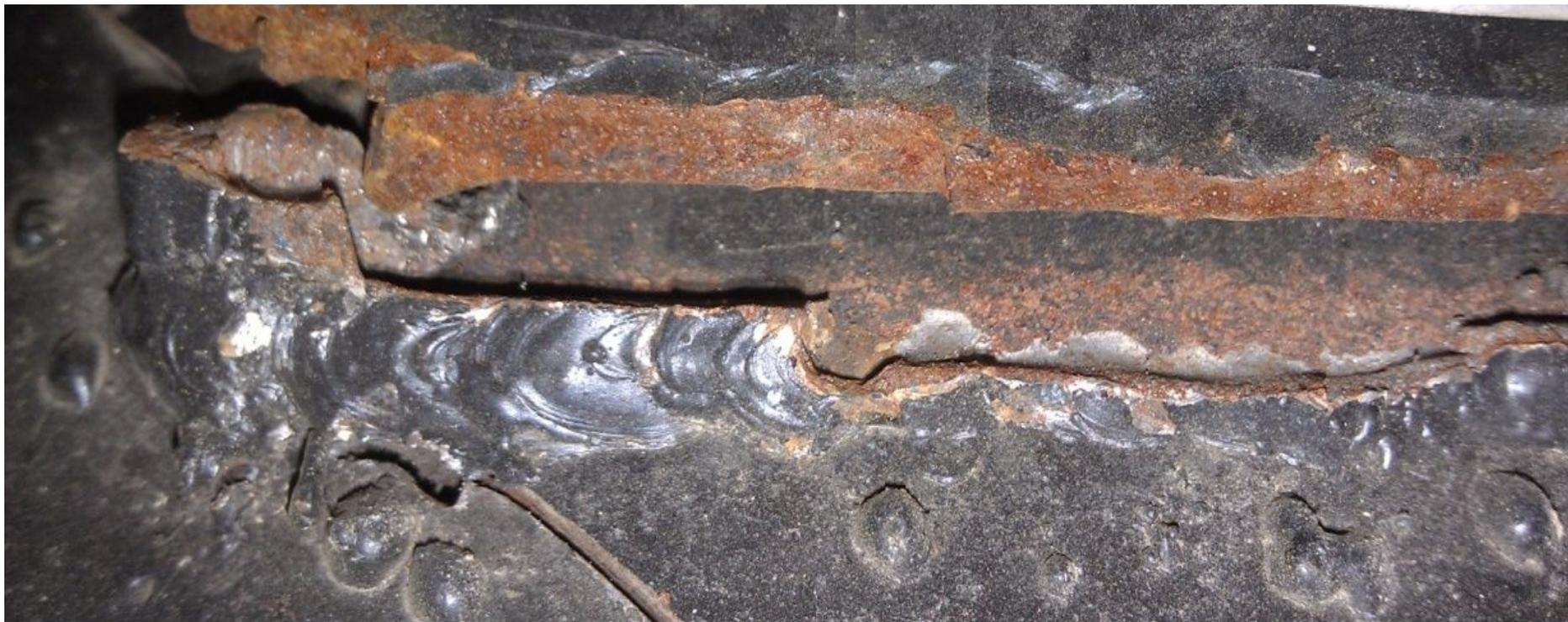
Рис.6. Разрушение сварного шва в результате непровара. На поверхности видны брызги металла.
