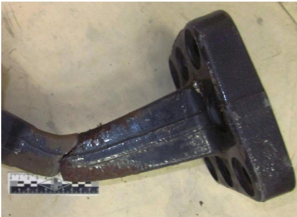
**Рис.30. Разрушенная петля дышла прицепа. Разрушение произошло с сильной пластической деформацией от изгибающей нагрузки**
