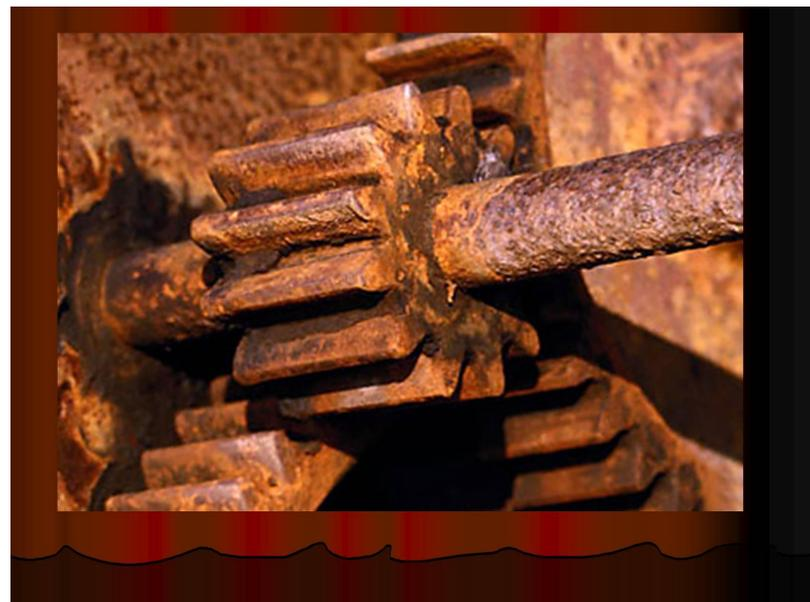
**Коррозия** (от лат. *corrosio* - разъедание) - это самопроизвольное разрушение металлов в результате химического или физико-химического взаимодействия с окружающей средой. Коррозионные разрушения в этом случае развиваются при воздействии на поверхности таких агрессивных веществ, как химически активные газы, кислотные примеси смазочных материалов, почва и др.
