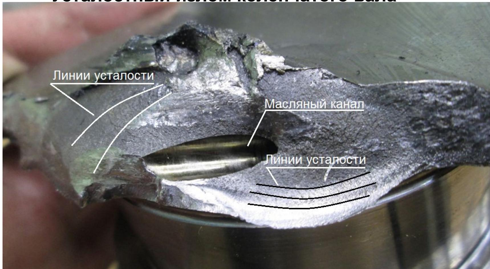
Рис.5. Разрушение началось от масляного канала и распространялось в двух направлениях: к шатунной и коренной шейкам.
