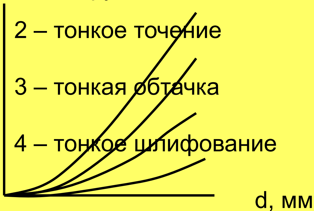
Рис.2.1 – Зависимость поля рассеивания от диаметра обрабатываемой детали.
