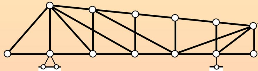
$$\left. \begin{array}{l} Y = 13 \\ C = 23 \\ C_0 = 3 \end{array} \right\} W = 2Y - C - C_0 = \\ = 2 \cdot 13 - 23 - 3 = 0 \text{ —} \\ \text{система может быть} \\ \text{геометрически неизменяемой}$$
