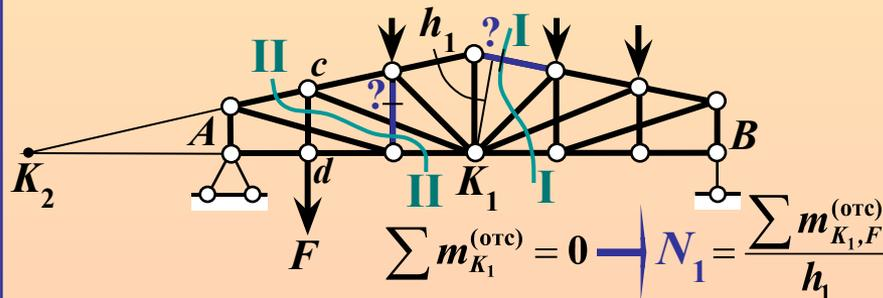
2. Сечение проходит более чем по трём стержням, но неизвестны усилия в трёх (или менее) из них – остальные уже определены ранее.
