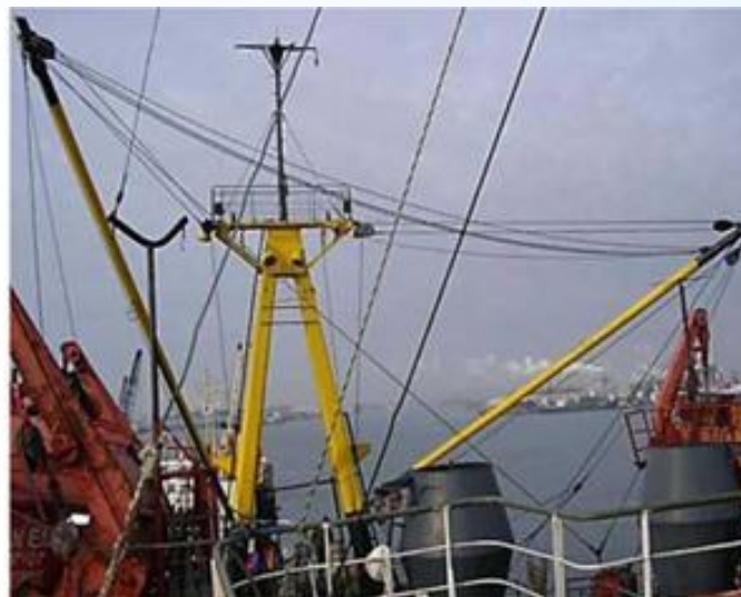
а) – соединение грузовых шкентелей при работе на «телефон»; б) – грузовой блок
