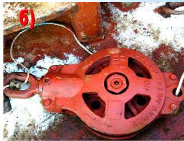
а) – соединение грузовых шкентелей при работе на «телефон»; б) – грузовой блок
