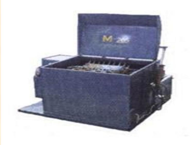
Моечная установка для мойки блоков цилиндров
