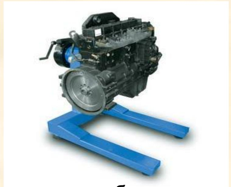
Стенд для разборки и сборки двигателя
