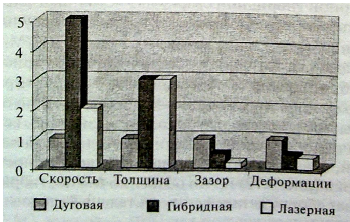
Сопоставление технологических характеристик трех способов сварки
