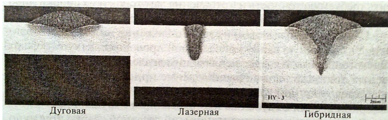
Сопоставление формы сечения шва при трех способах сварки (скорость сварки одинакова)
