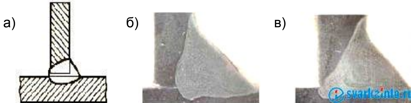
Рисунок 2 – Сварные швы : а – схема поперечного сечения таврового шва; б – макрошлиф углового шва; в – макрошлиф таврового шва
