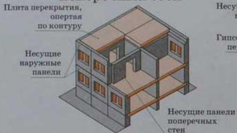
с большим шагом несущих поперечных стен
