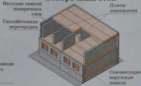
со смешанным шагом несущих поперечных стен
