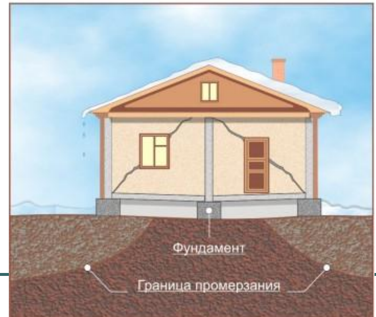
Деформация дома на пучинистом грунте
