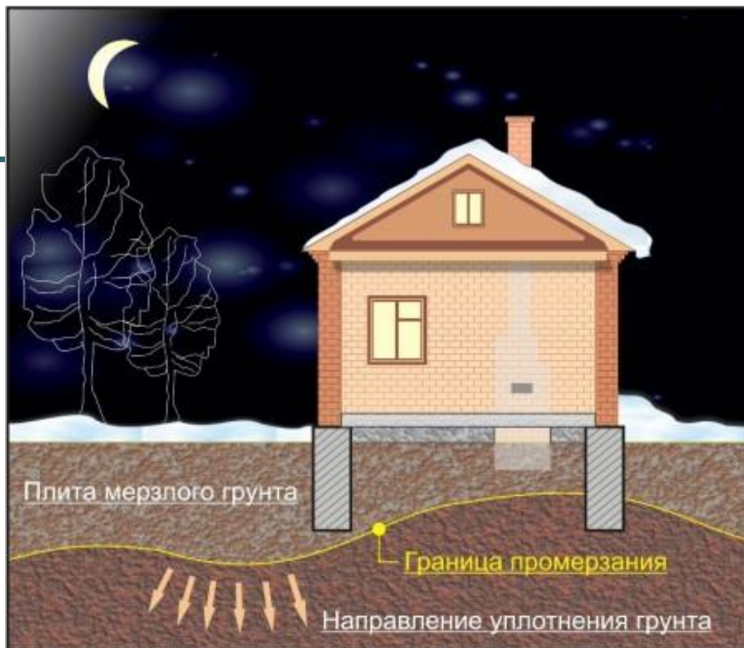
Плита мерзлого грунта ночью
