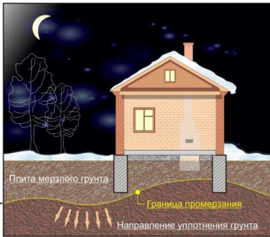
Плита мерзлого грунта ночью
