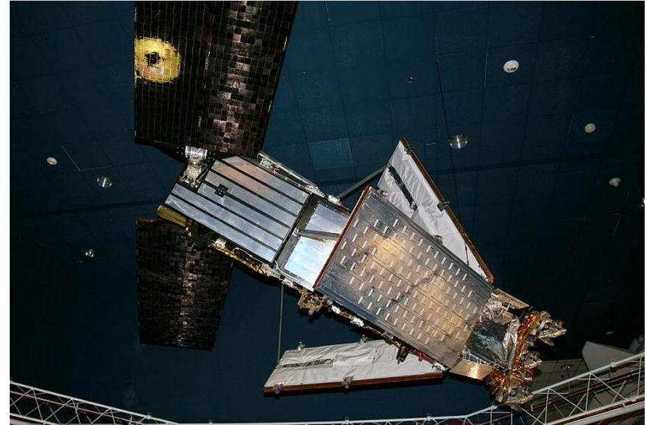
Фазированная антенная решётка имеет 48 лепестков формирующих 16 лучей в трех секторах. Четыре межспутниковые антенны обеспечивают пропускную способность 10 Мбит/с для каждого аппарата.
