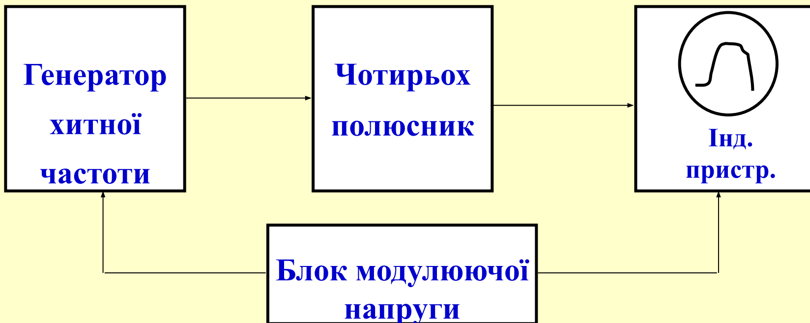
Рис. 3. Структурна схема найпростішого автоматичного вимірювача АЧХ
