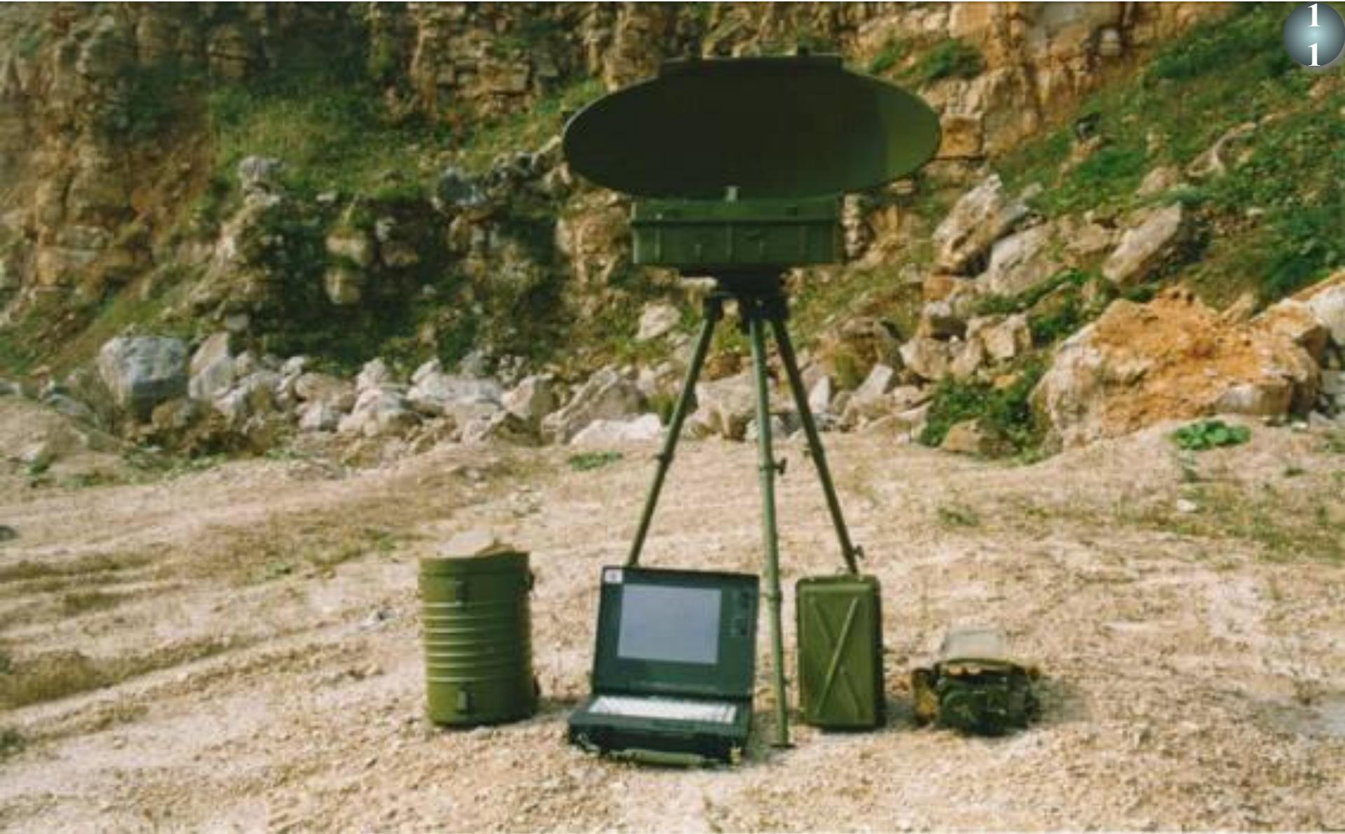
Переносная станция наземной разведки ПСНР-8 предназначена для разведки движущихся наземных (надводных) целей и обслуживания стрельбы артиллерии. Дальность разведки и обслуживания стрельбы – до 15 км.
