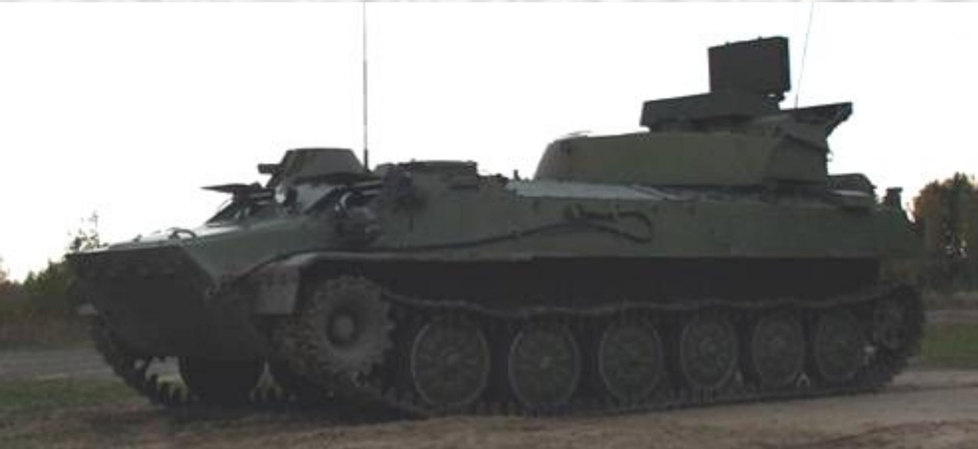
**Станция наземной артиллерийской разведки 1РЛ232-2 СНАР-10М предназначена для разведки движущихся наземных (надводных) целей и обслуживания стрельбы артиллерии. Дальность разведки и обслуживания стрельбы – до 40 км.**
