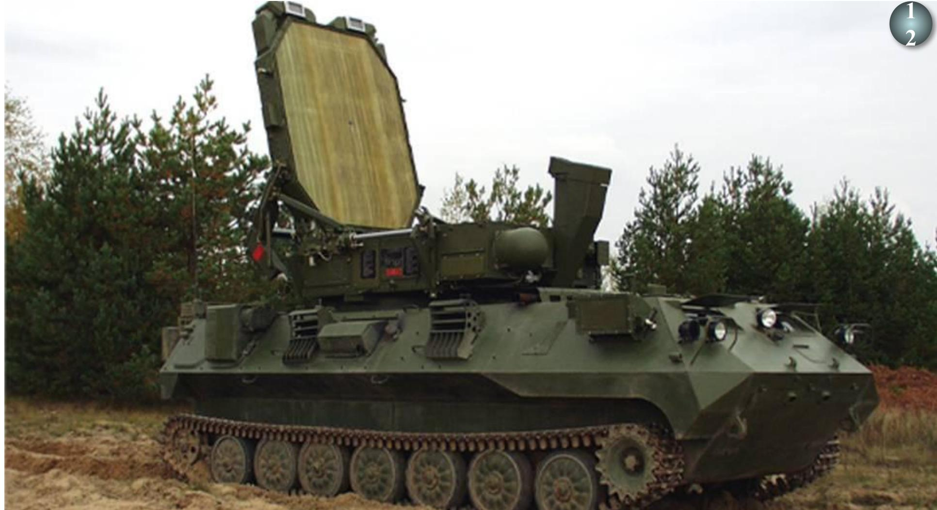
**Радиолокационный комплекс 1Л219М «Зоопарк – 1» предназначен для разведки по выстрелу (пуску) огневых позиций стреляющих минометов, артиллерии, РСЗО, стартовых позиций тактических ракет и обеспечения стрельбы (пусков) своей артиллерии, тактических ракет, а также наведения управляемых средств поражения. Дальность разведки и обслуживания стрельбы - до 45 км.**
