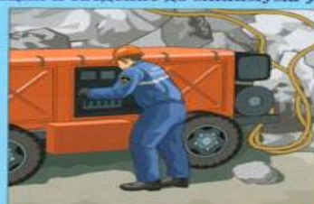
Подача воздуха в заваленные защитные сооружения с порождежными фильтровентиляционными системами
