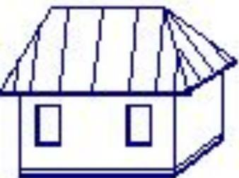
**Вальмовая крыша.** Она четырехскатная: два ската представляют собой трапеции, а два других, со стороны торцевых стен, - треугольники (они называются **вальмами**). Разновидностью вальмовой крыши является полувальмовая.
