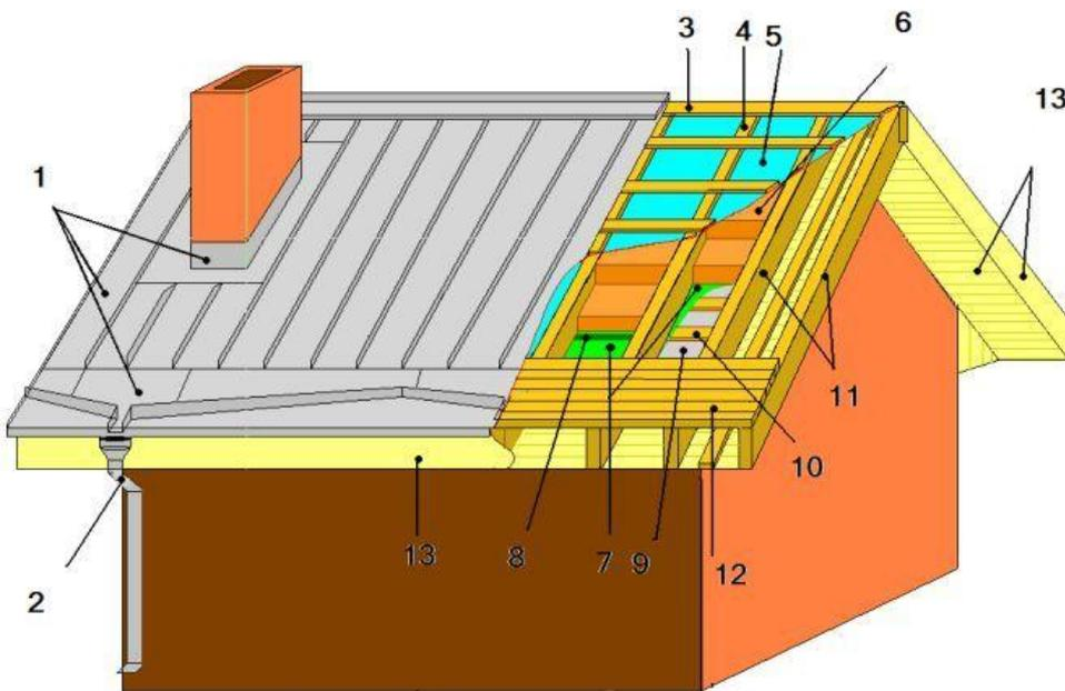
**Фальцевая** кровля является одним из самых надежных и практичных покрытий кровли. Небольшой вес (1 кв. м весит 4- 5 кг).
