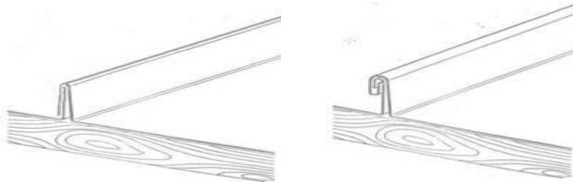
Устройство одинарного фальца возможно на кровлях с уклоном от 30 до 60% (16...30°).
