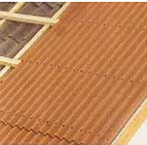
Волокнистые (гофрированные) листы **GUTTA** - легкий кровельный материал, изготовленный путем компрессии при высоком давлении и температуре пропитанных битумом органических волокон.
