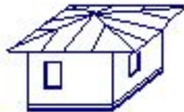
**Шатровая крыша**. Все скаты такой крыши, в виде равнобедренных треугольников, сходятся в одной точке. Определяющим элементом в ней является симметричность. Применяется для строений в форме квадрата или равностороннего многоугольника.
