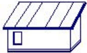
**Односкатная крыша** опирается своей несущей конструкцией (системой стропил, фермой и др.) на наружные стены, находящиеся на разных уровнях. Односкатные крыши применяются чаще всего при строительстве веранд и террас, хозяйственных построек, складских помещений.
