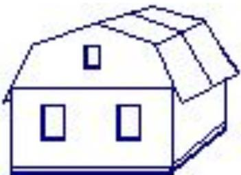
**Мансардные крыши.** Для увеличения объема жилого чердачного помещения (**мансарды**), часто выполняются скаты различных уклонов: нижние - более крутые и верхние - более пологие. Данный тип конструкции крыши очень популярен при современном строительстве, т.к. обеспечивается эффективное использование жилой площади мансардного этажа.
