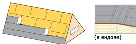
Монтаж самоклеящейся карнизной гибкой черепицы производят вдоль карнизного свеса, предварительно удалив с ее нижней поверхности защитную пленку. Карнизную черепицу укладывают стык в стык, отступив вверх от места перегиба карнизной планки 10-20 мм. Прибивают карнизную черепицу вблизи мест перфорации с последующим перекрытием мест крепежа рядовой
