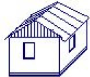
**Двускатная крыша** является самой распространённой классической конструкцией. Её еще называют щипцовой. Существуют варианты крыш с висячими стропильными формами или с наклонными стропилами. К многочисленным вариантам данного типа надо отнести крыши с равномерным или неравномерным углом наклона ската или же размером карнизного свеса.
