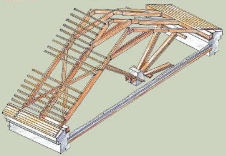
**Наслонные стропила** устанавливают в домах со средней несущей стеной или столбчатыми опорами
