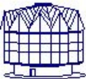
**Многощипцовая крыша.** Её устраивают на домах со сложной многоугольной формой плана. Такие крыши имеют большее количество **ендов** (внутренний угол) и **ребер** (выступающие углы, которые образуют пересечения скатов кровли), что требует высокой квалификации при выполнении кровельных работ.
