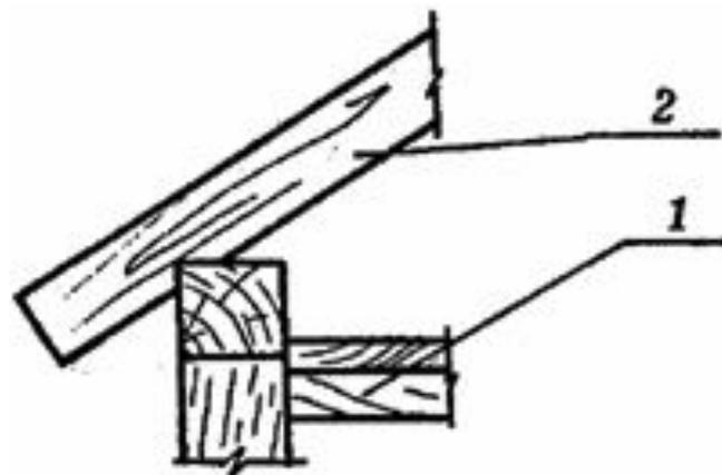
Опираие наслонных стропил в деревянных каркасных зданиях:
