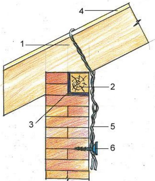
Чтобы крышу не снесло ветром, стропила крепят к стене с помощью металлических хомутов или свитых из проволоки тросиков, которые закрепляют за вбитый в стену штырь или ерш.
