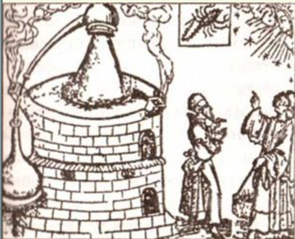
Печь для дистилляции (из сочинения Гебера)
