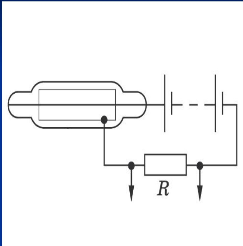
Основа счетчика Гейгера - трубка, заполненная газом и снабженная двумя электродами, на которые подается высокое напряжение. Действие счетчика основано на ударной ионизации. Когда элементарная частица пролетает сквозь счетчик, она ионизирует газ, и ток через счетчик очень резко возрастает. Образующийся при этом на нагрузке импульс напряжения подается к регистрирующему устройству.
