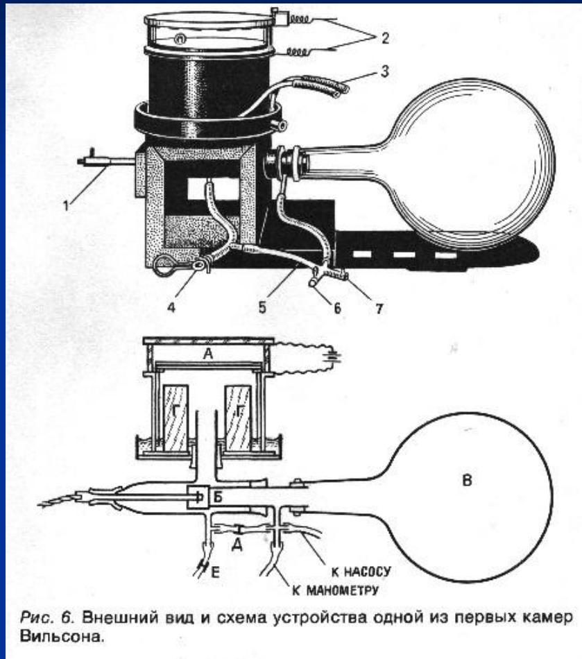
Рис. 6. Внешний вид и схема устройства одной из первых камер Вильсона.
