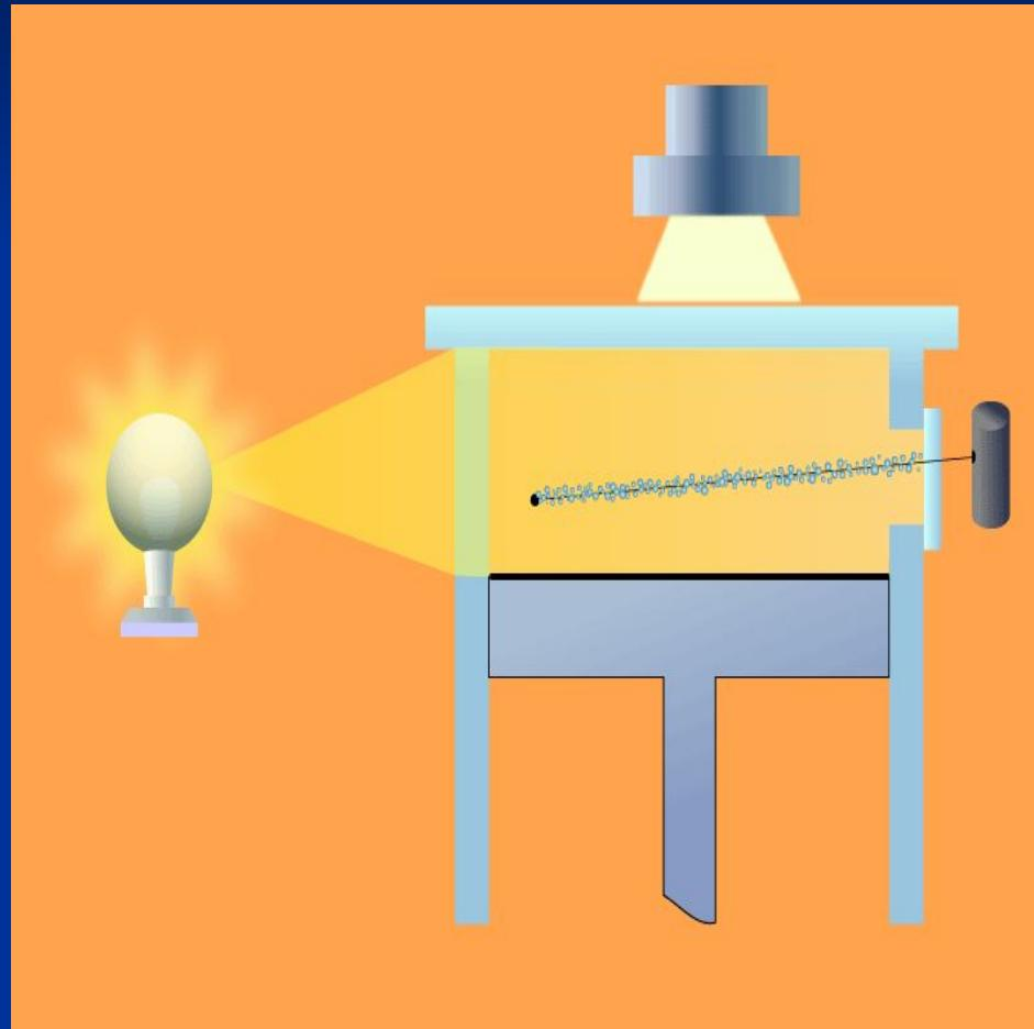
■ Камера Вильсона представляет собой герметичную камеру, заполненную перенасыщенным паром. Частица, пролетая через камеру, вызывает конденсацию пара вдоль своей траектории. Оставшийся след фотографируется через стеклянную стенку камеры.
