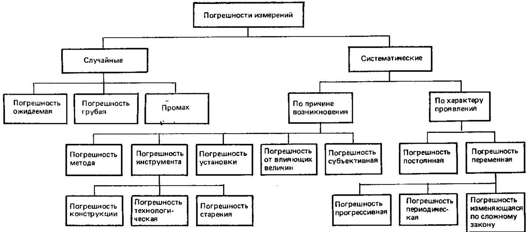
Рис. 1.7. Классификация погрешностей измерений
