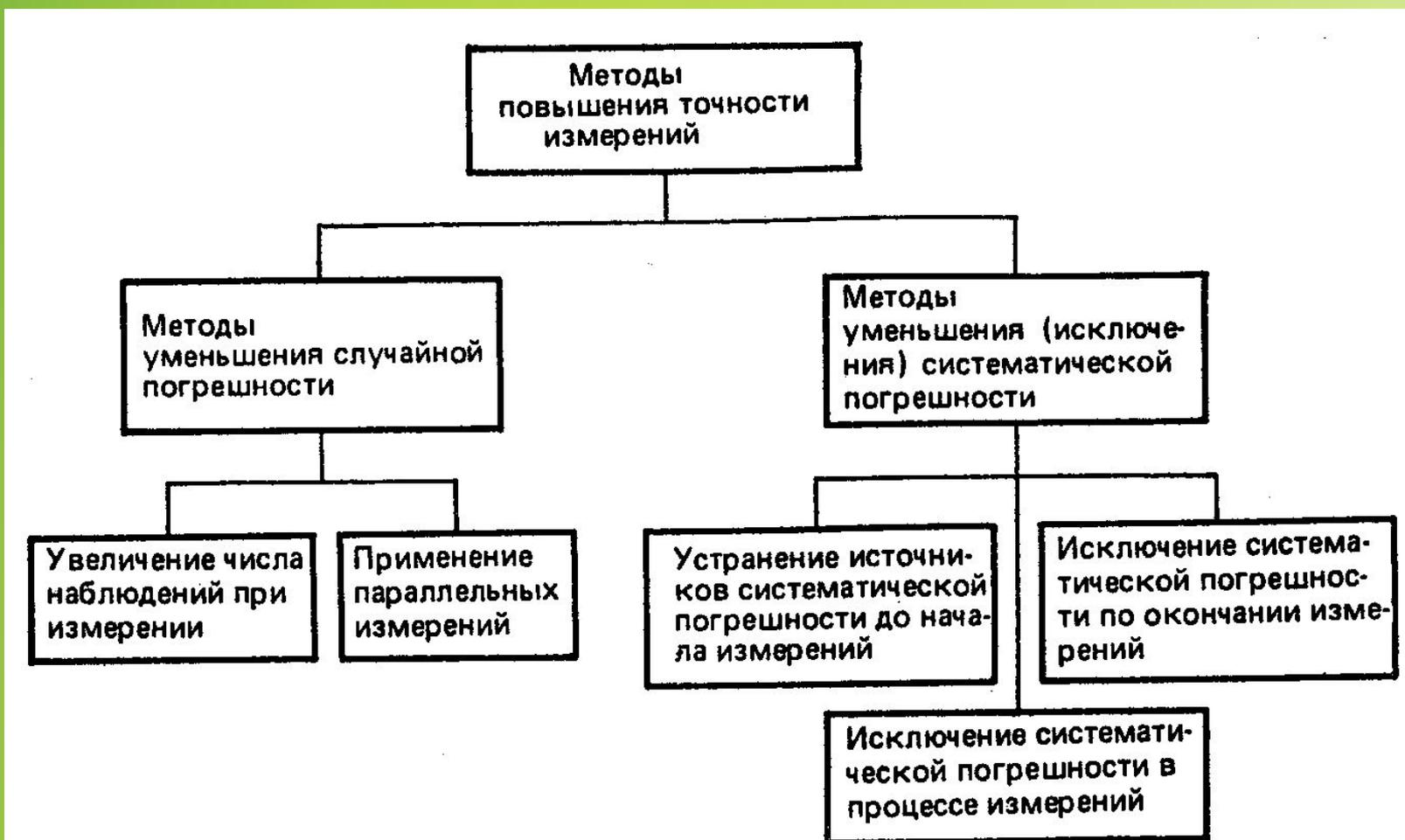
Рис. 3.5. Классификация методов повышения точности измерений
