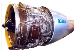
Авиационный двигатель ПС-90А
