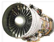
Авиационный двигатель Д-30
