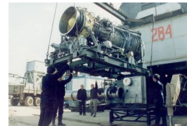
запуск 84-01 (12 МВт) на стенде 284
