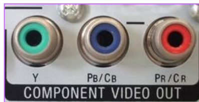
Сигнал яркости Y Раздельный сигнал цветности Pb, Pr
