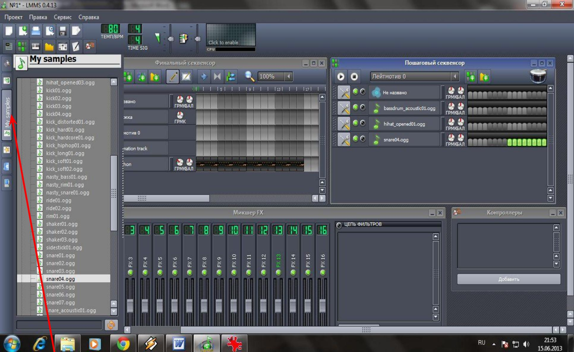
Эта вкладка содержит коллекцию образцов (семплов), которая поставляется с LMMS. При нажатии на вкладку "Мои образцы" должен появиться список папок, одна из них с надписью "drums". Двойной щелчок на ней откроет список ударных инструментов. Нажимайте на них, чтобы услышать звуки различных инструментов.
