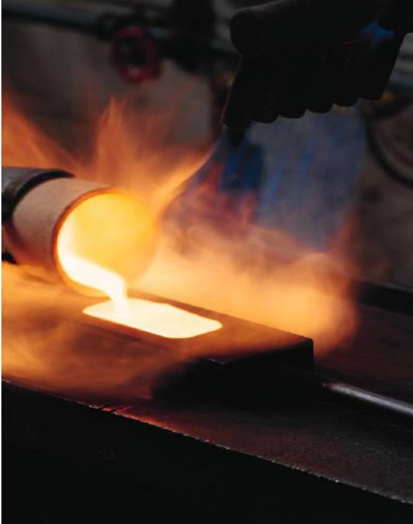
**ПЛАВКА** - это тепловая обработка **ШИХТЫ** в **ПЛАВИЛЬНОЙ ПЕЧИ** для выделения из нее **МЕТАЛЛОВ**.
