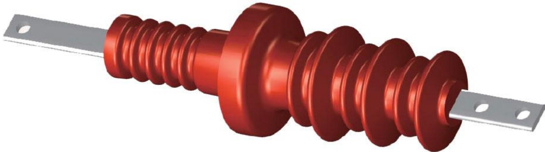
Проходные изоляторы различают по роду установок (для внутренней и наружной), напряжению (6 или 10кВ) и разрушающей нагрузке. В обозначении проходных изоляторов указывают: тип изолятора П (проходной), номинальное напряжение, номинальный ток и разрушающую нагрузку на изгиб. Например, проходной изолятор на напряжение 10кВ для номинального тока 400А с разрушающей нагрузкой 750 кгс обозначается П- 10/400-750.
