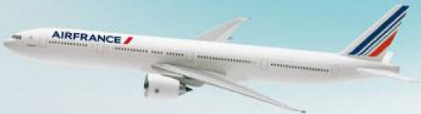
Задняя часть самолета оснащена **хвостовым оперением**, которое придает машине устойчивость. И крыло, и хвостовое оперение прикрепляются к **корпусу** самолета — **фюзеляжу**. В нем расположены кабина экипажа, механизмы управления самолетом, салон для пассажиров, грузовые отсеки.
