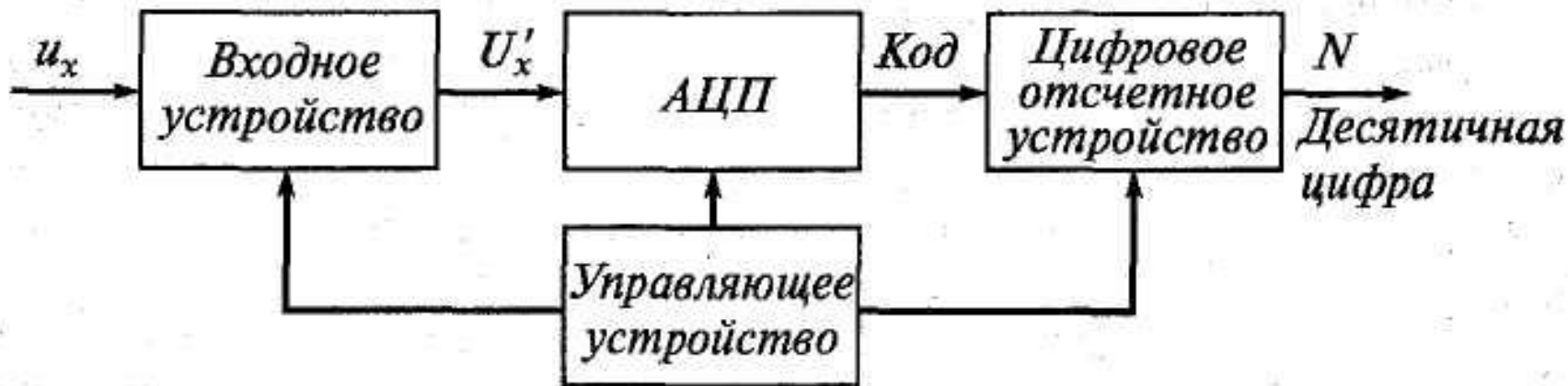
Рисунок 4 - Упрощённая структурная схема цифрового вольтметра
