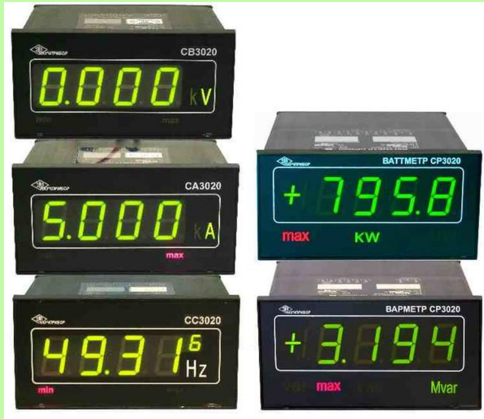
Рисунок 1 – Иллюстрация определения цены деления цифрового измерительного прибора
