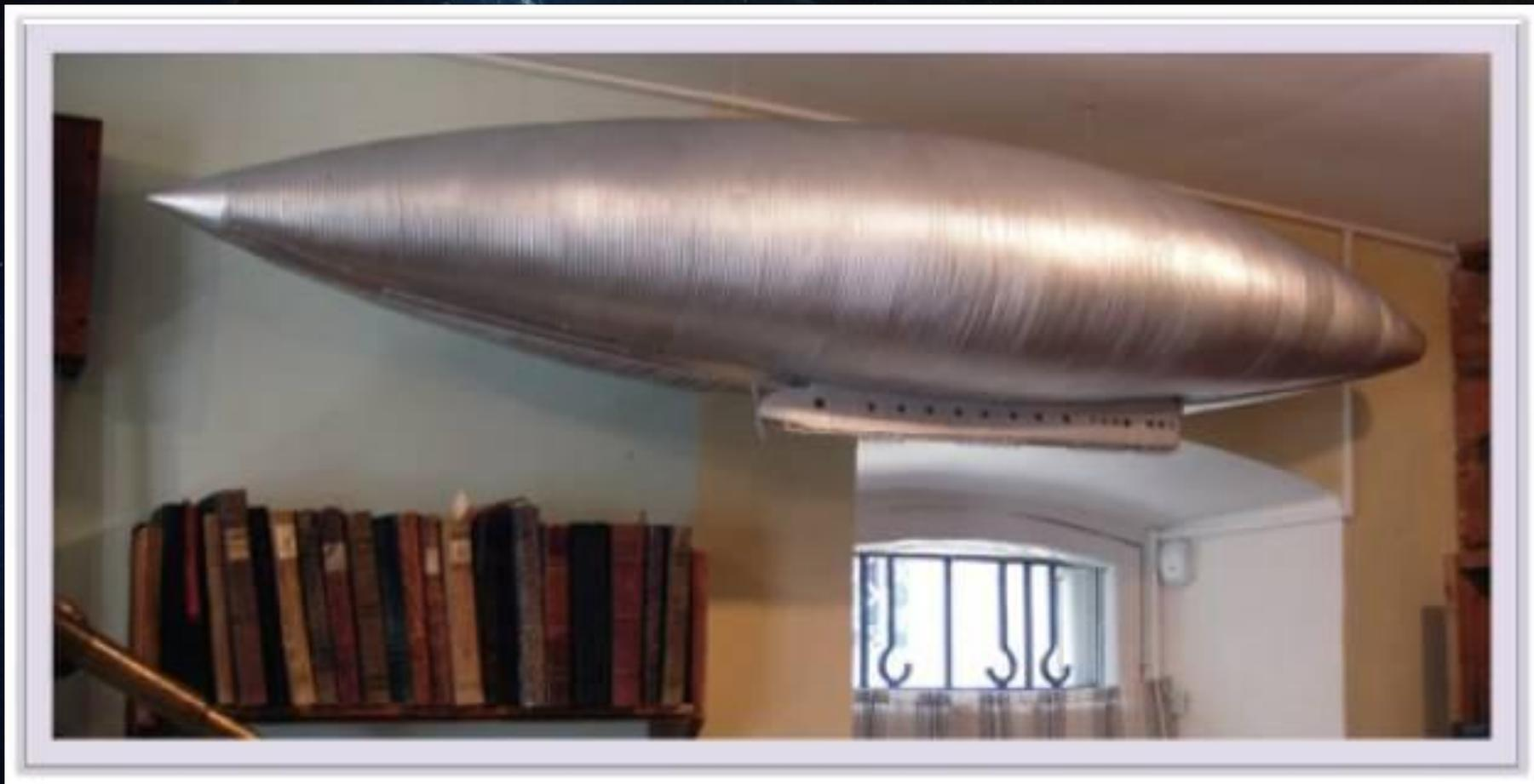
**Модель оболочки аэростата из гофрированного металла
