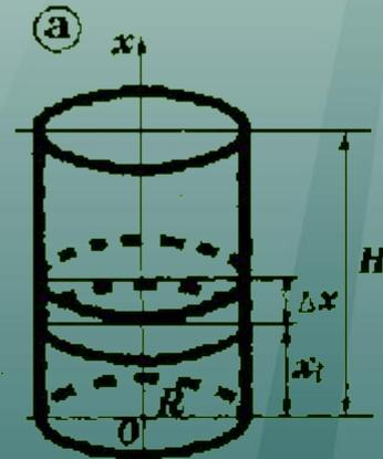
ВОДА ПОДАЕТСЯ ЧЕРЕЗ ОТВЕРСТИЕ В ДНЕ В ЦИЛИНДРИЧЕСКИЙ БАК ВЫСОТЫ  $H$  И РАДИУСА  $R$ . НАЙДИТЕ ЗАТРАЧЕННУЮ ПРИ ЭТОМ РАБОТУ.
