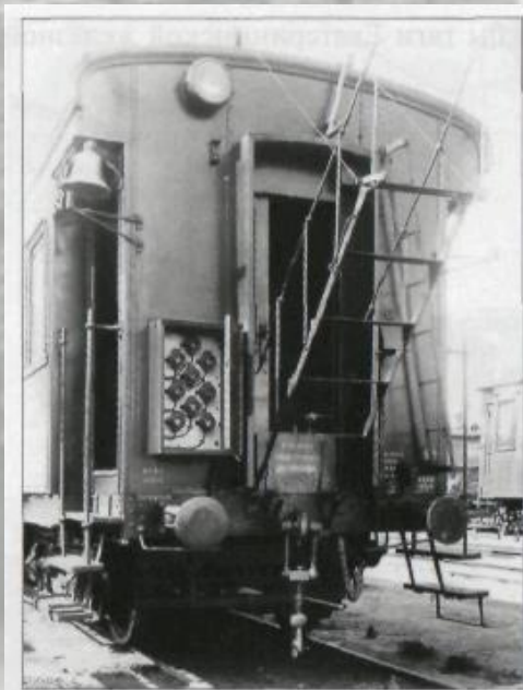
20. Динамометрический вагон снаружи, с лестницей для прохода на площадку маши- ниста через тендер
