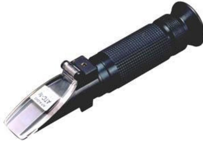
Модель АТС-1е устраняет необходимость в температурной компенсации. Революционность нового инструмента позволяет измерять концентрацию вашего образца, не беспокоясь о температуре.
