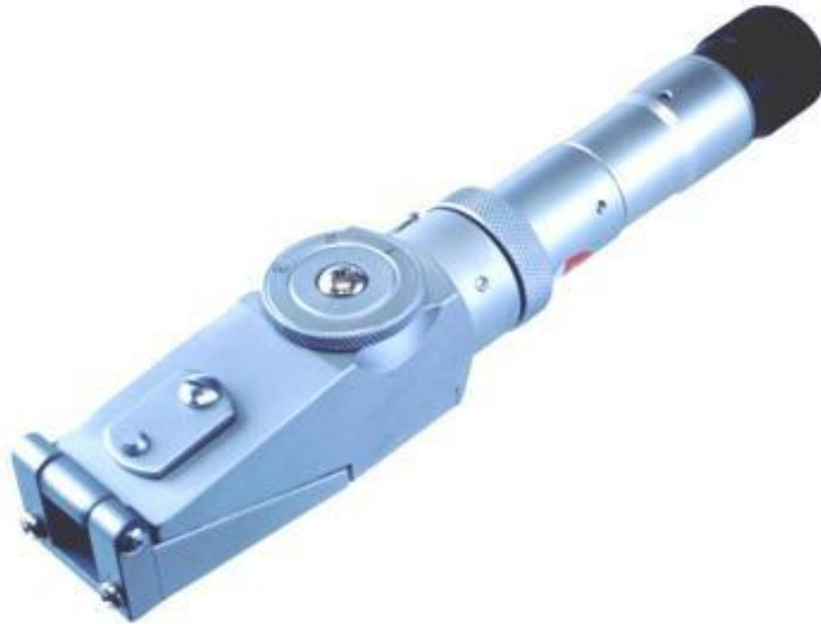
Коэффициент преломления в растворе, содержащем сахар, пропорционален концентрации сахара. Модель 500 использует этот принцип, где применяется передающая система, для получения высокой контрастности поля зрения.
