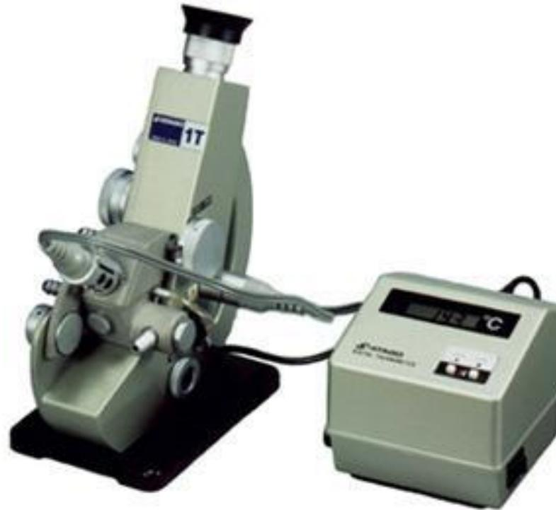
Модель 1Т представляет собой Abbe-рефрактометр стандартного типа, измеряющий индекс преломления жидкостей и твердых веществ быстро и точно. Она специально разработана, чтобы показывать индекс преломления D-линии без использования натриевой лампы.
