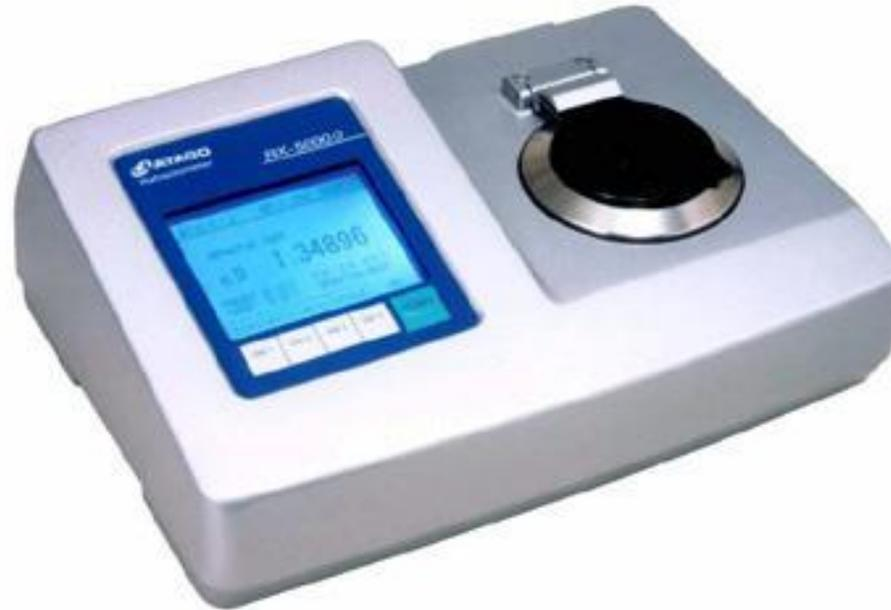
Модель RX-5000a представляет собой автоматический цифровой рефрактометр, который устанавливает температуру измерения и может точно и быстро измерять индекс преломления, брикс или концентрации различных жидкостей.
