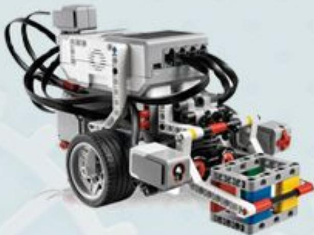
**Микрокомпьютер EV3** служит центром управления и энергетической станцией робота
