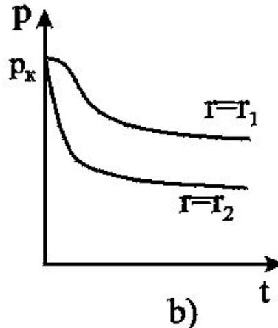
Пьезометрические кривые при неустановившемся притоке газа к скважине в разные моменты времени (а) и изменение давления с течением времени в фиксированных точках пласта (б)
