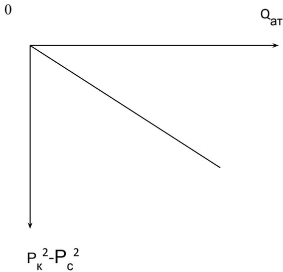
Индикаторная диаграмма при фильтрации газа строится в координатах  $Q_{ат} - (P_k^2 - P_c^2)$  и в установившемся плоскорадиальном потоке имеет прямолинейный характер
