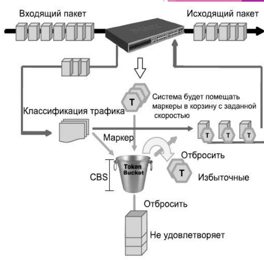
**Рис. 4.9.** Алгоритм "корзина маркеров" в рамках механизма Traffic Policing
