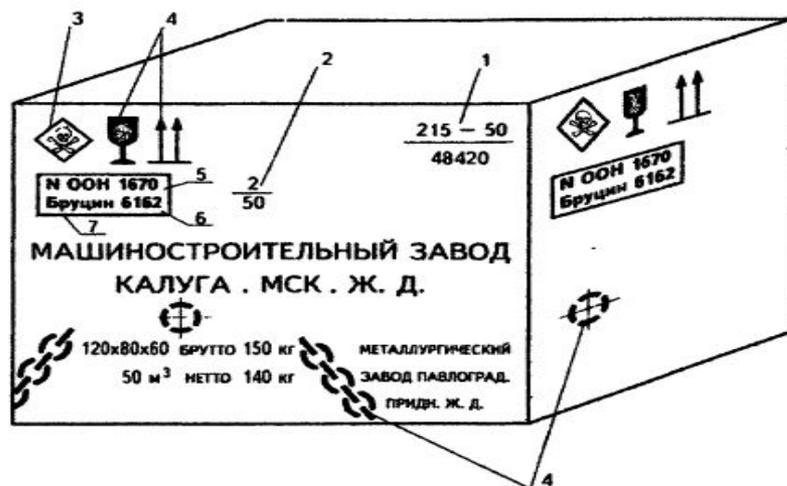
**Рис. 3.5.** Расположение маркировки транспортной тары, содержащей опасный груз:
