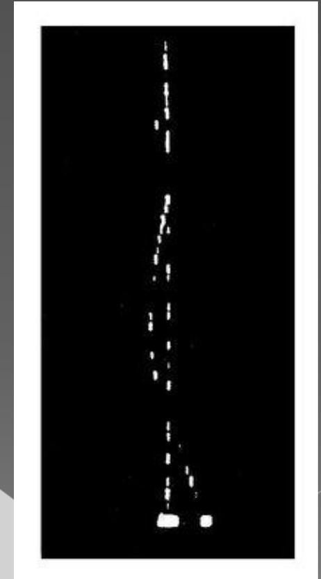
Трек частицы в узкозасорной искровой камере
