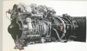
ВК-2500 – это дальнейшее развитие двигателя ТВ3-117. Преимуществами нового двигателя являются высокая топливная экономичность, повышенные мощностные характеристики, применение современной системы автоматического управления.
