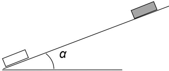
Определение коэффициента трения по зависимости ускорения от угла наклона
