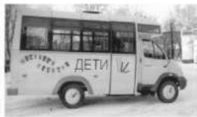
Рис. 2. Экспериментальный 13-местный автобус на шасси автомобиля «Мамонт»
