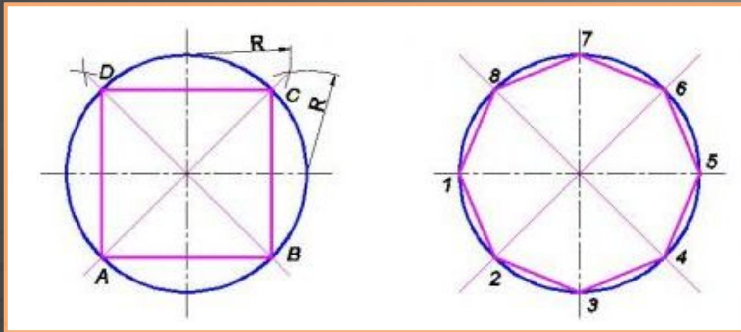
Применяя известный прием деления прямого угла на две равные части при помощи циркуля или угольника строят биссектрисы прямых углов, которые пересекаясь с окружностью в точках 2, 4, 6 и 8 делят каждую четвертую часть окружности пополам.
