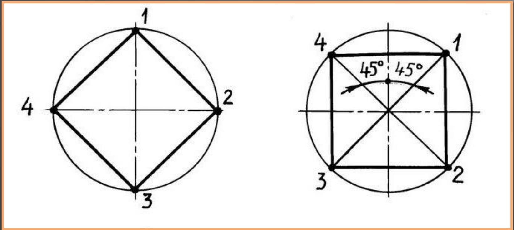
Деление окружности на четыре равные части и построение правильного вписанного четырехугольника можно выполнить циркулем и линейкой. Две взаимно перпендикулярные центровые линии делят окружность на четыре равные части. Соединив точки пересечения этих линий с окружностью прямыми, получают правильный вписанный четырехугольник.
