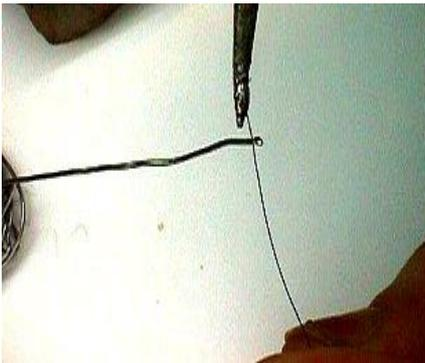
3. После этого конец провода припаивается в необходимое место. Затем провод протягивается ко второму месту пайки и огибается вокруг него таким образом, чтобы образовался острый угол, указывающий на место на проводе, которое будет припаиваться.
