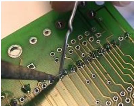
3. Теперь жало паяльника следует обвести по полукругу вокруг обрабатываемого контакта, одновременно перемещая припой во встречном направлении. Таким образом на место пайки наносится еще около 1 мм припоя. Место пайки нагрето настолько, что расплавившийся припой под действием сил поверхностного натяжения равномерно распределяется по всей контактной площадке.
