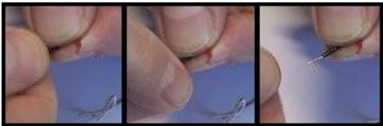
1. Снять изоляцию с концов провода. Тонкие медные проводники абсолютно чисты, так как они были защищены изоляцией от кислорода и влажности.
