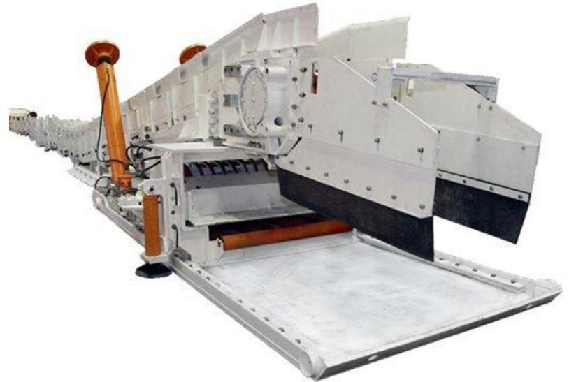
**6. Штрековый перегружатель** предназначен для перегрузки руды.
