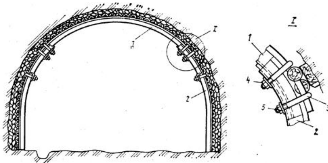
Рис. 104. Металлическая арочная трёхзвенная податливая крепь АП-3:
