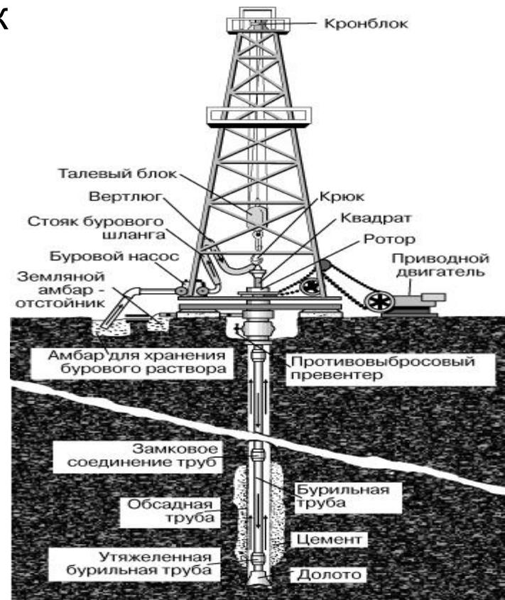
При вращательном бурении разрушение породы происходит в результате одновременного воздействия на долото нагрузки и крутящего момента. Под действием нагрузки долото внедряется в породу, а под влиянием крутящего момента скалывает ее.
