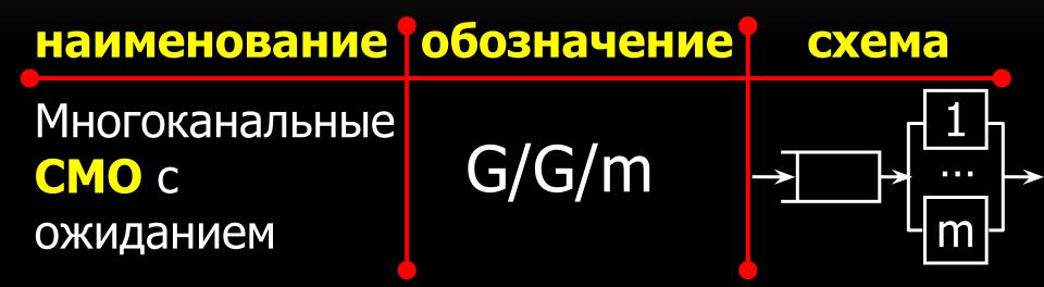
Несколько параллельно работающих обслуживающих приборов с общей бесконечной очередью. Моделируют группы абонентских терминалов ВС, работающих в диалоговом режиме
